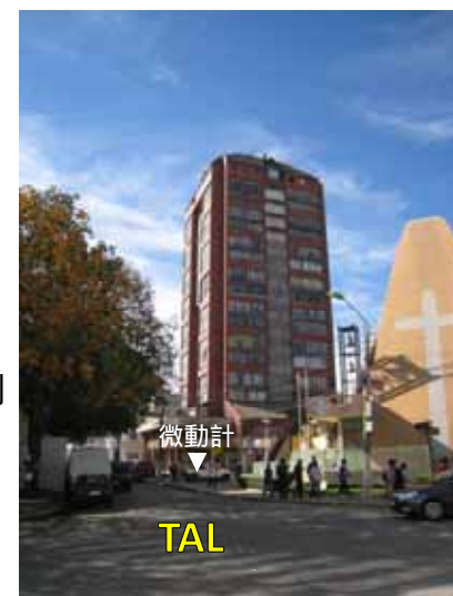
深度12mに固い層があり、そこまで地下室があるらしい卓越周期0.3s程度の微動観測結果とも整合する
