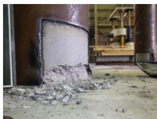
写真 2 実験ケース 1 破壊状況
